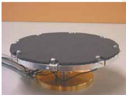
図1. 8chマイクロホンアレーによる音源分離
